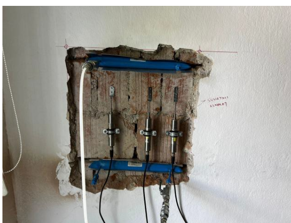
Foto 3. Testimi i muraturës, përcaktimi i rezistencës në shtypje dhe moduli i elasticitetit me metodën “Flat Jack”
