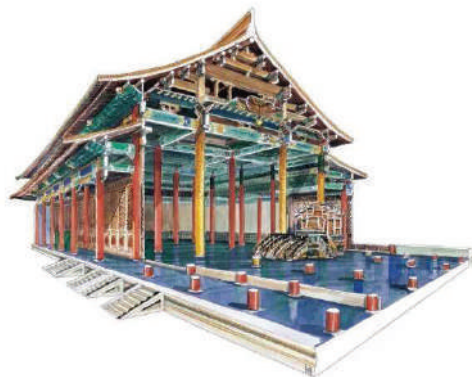
Fig. 14. Sistemi kinez i ndërtimit me shtylla dhe trarë
