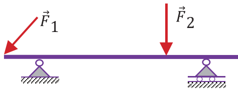
Fig. 101. Trari i thjeshtë me lëshime – konsola nga dy anët e tij.
